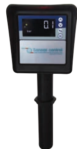
PLASTÓMETRO con un indicador PRESIÓN
